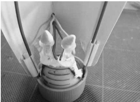
図10 室靭帯と声帯靭帯に相当するゴムヒモで甲状軟骨と披裂軟骨が連結される
